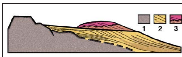
Figura 3: Tall esquemàtic del sud-est de Menorca. 1: Substrat paleozoic. 2: Unitat de Barres (Tortoniana inferior), on estan excavats els soterranis de Sant Felip. 3: Complex escullós del Tortoniana superior—Messinià inferior.
